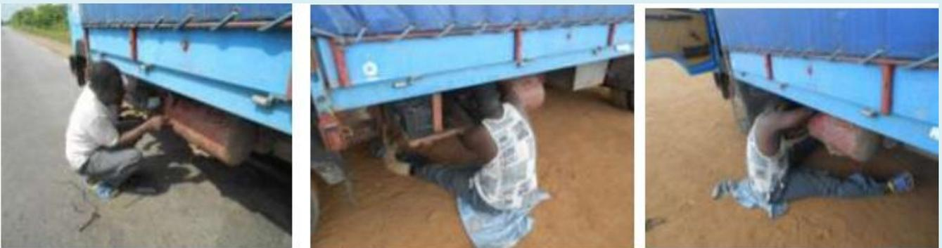
Nous nous sommes conduits vers un mécanicien qui a été obligé de démonter la batterie et de changer les boulons qui sont à la tête afin de relacer les câbles électriques.
